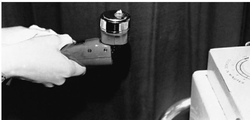
Ryc. 4-3. Kropla wody umieszczona na głowicy przetwornika zaczyna kipieć mimo braku dostrzegalnych zmian temperatury. Dowód mechanicznego działania ultradźwięków, niezależnego od efektu cieplnego.
